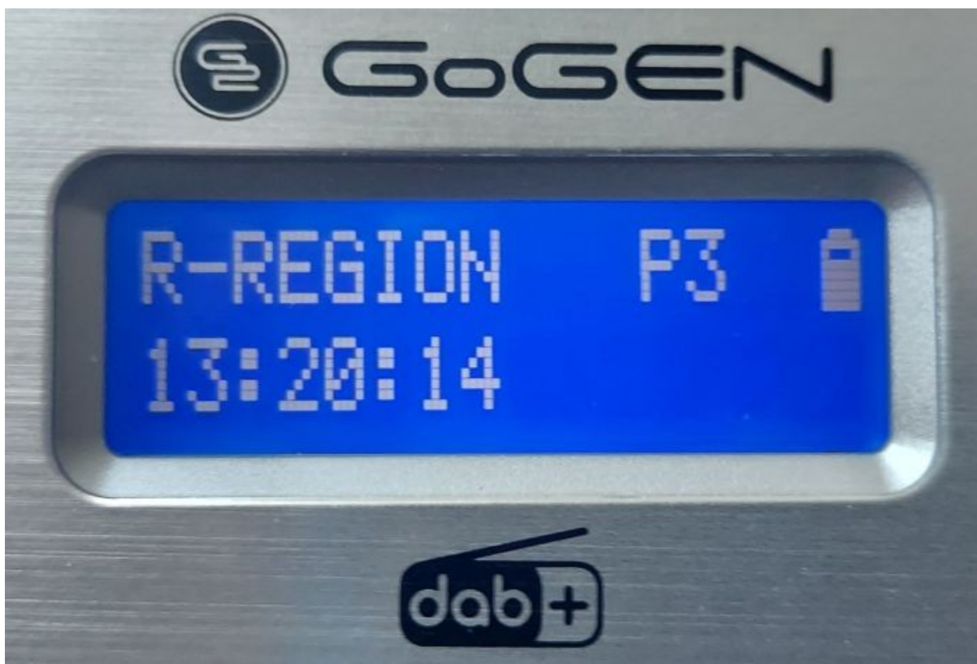
Přes tlačítko Info přepínáte údaje jdoucí s vysíláním, zde konkrétně jde o VKV. Na displeji můžete mít i datum, druh pořadu či frekvenci, u DAB například datový tok, tedy vysílací kvalitu.
