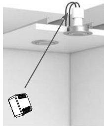
montáž do podhledu
