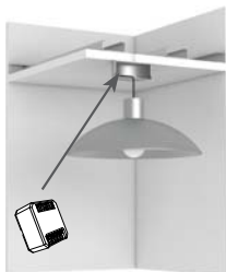
montáž do krytu svítidla
